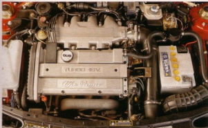
Bajo unas tapas de balancines con el anagrama de Alfa Romeo se esconde el vigoroso motor turbo del Delta HF integrale.
