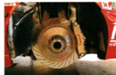
Los frenos delanteros de acero pueden montar pinzas Brembo de cuatro a ocho bombines.
