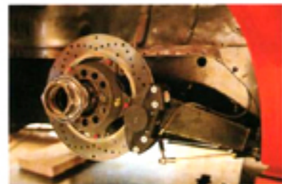
Para la frenada trasera bastan unos minúsculos discos y pinzas procedentes del motociclismo.
