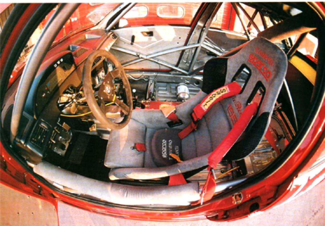
El habitáculo, limpio de guarnecidos, está presidido por el puesto de conducción entre una jaula de barras.
