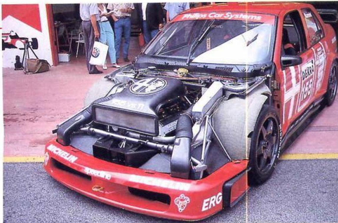
El capó se desmonta totalmente, dejando accesibles la mayoría de los órganos mecánicos.
