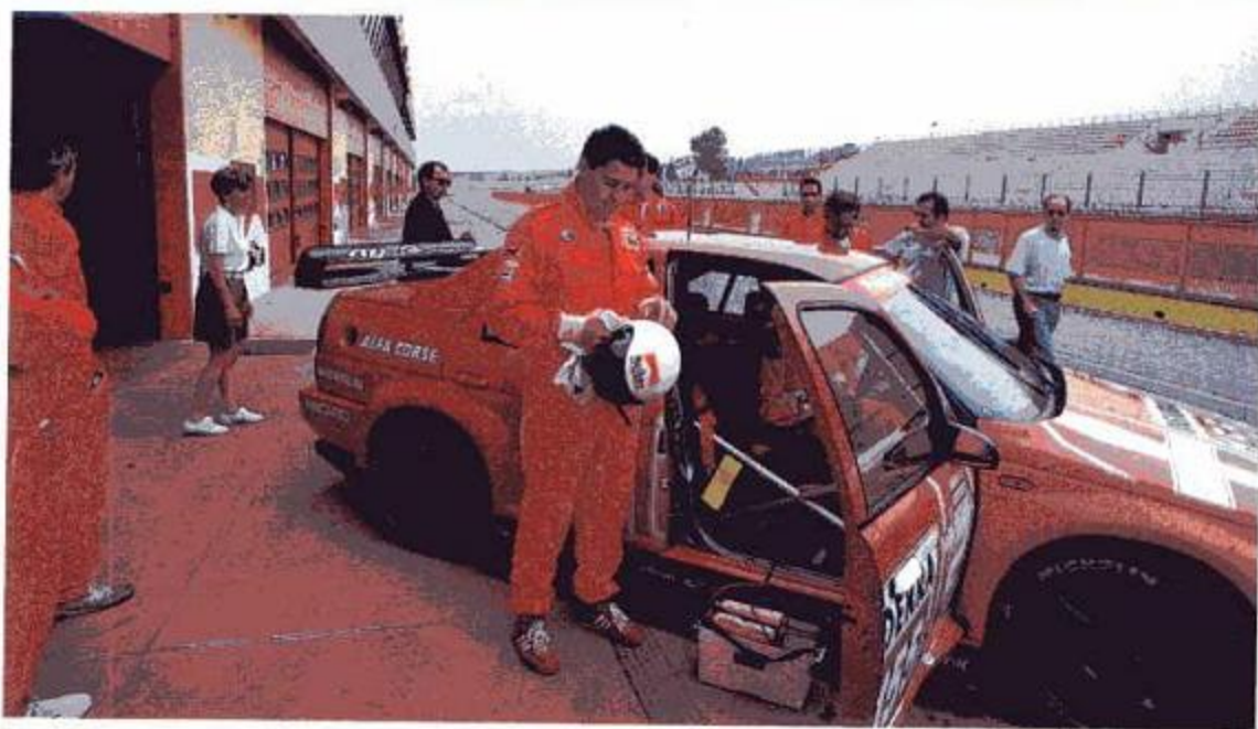
Para favorecer la puesta en marcha, el Alfa se ayuda de unas baterías exteriores.
