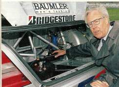
„Zur Verstellung der Stabilisatoren verwendet Mercedes Wischermotoren von Bosch“
