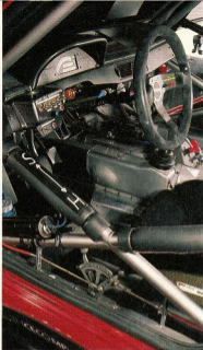
Arbeitsplatz Alfa: Drehzahlmesser-Leuchtband, Schalterbrett und Hebelwerk für die Stabilisatoren
