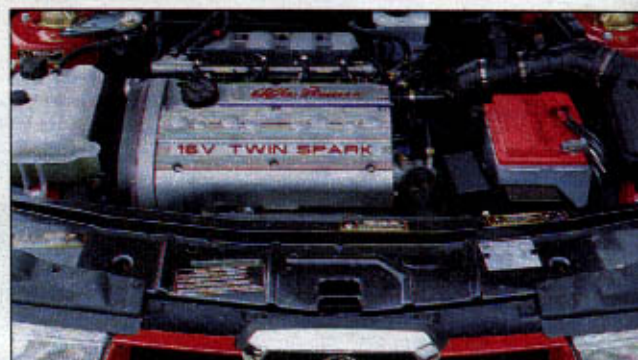
Het hart van de vernieuwde 155 is de van de vijfcilinder Lancia K afgeleide vierpitter van 150 pk.
