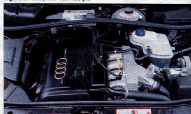
De 20-klepsmotor van de Audi A4 1.8 Turbo is stiller en zuiniger, maar stukken minder inspirerend dan de Alfa-krachtbron.
