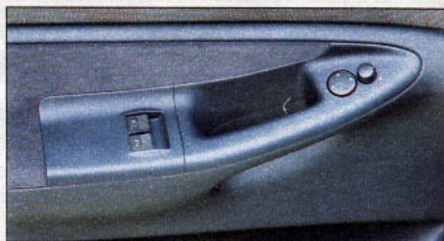
Kan beter: de plaatsing van de raamschakelaars in de Audi. Bij openen of sluiten van het portier worden de toetsen maar al te vaak per ongeluk geraakt.
