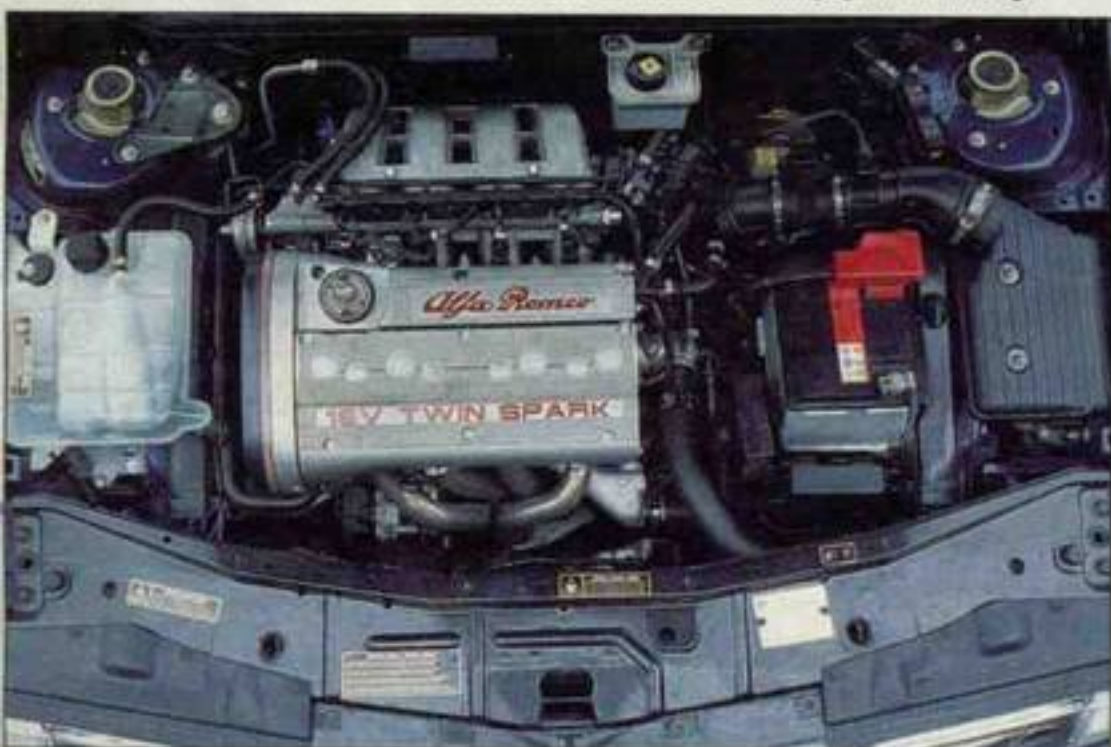
Nieuw hart voor de 155: de 1.8 met vier kleppen en twee bougies per cilinder.
